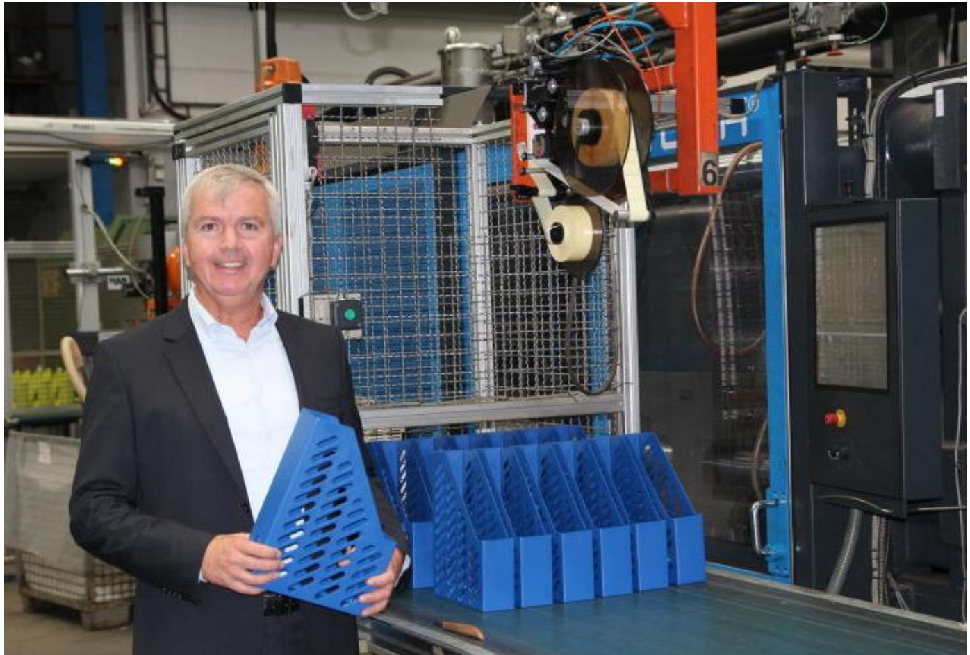
In der Produktionshalle: Geschäftsführer Ralf Niehaus steht vor einer sogenannten Spritzgussmaschine, in der die Büroartikel produziert werden. Er hält das fertige Produkt in der Hand, einen blauen Stehsammler.
